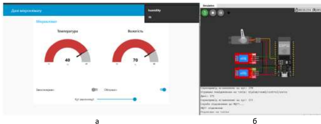
Рис. 4. Приклад IoT проекту у Wokwi / Node-RED: а – керуючі команди користувача; б – реакція пристроїв у Wokwi
